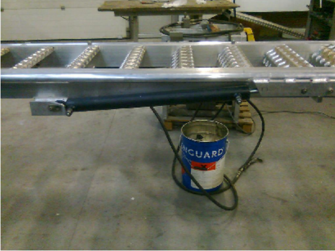
Hydraulisch neerklapbare leuning
